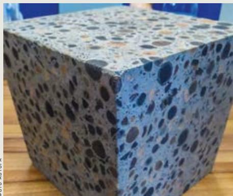
По словам г-на Лучая, бетон из цертида намного легче бетона из цемента
