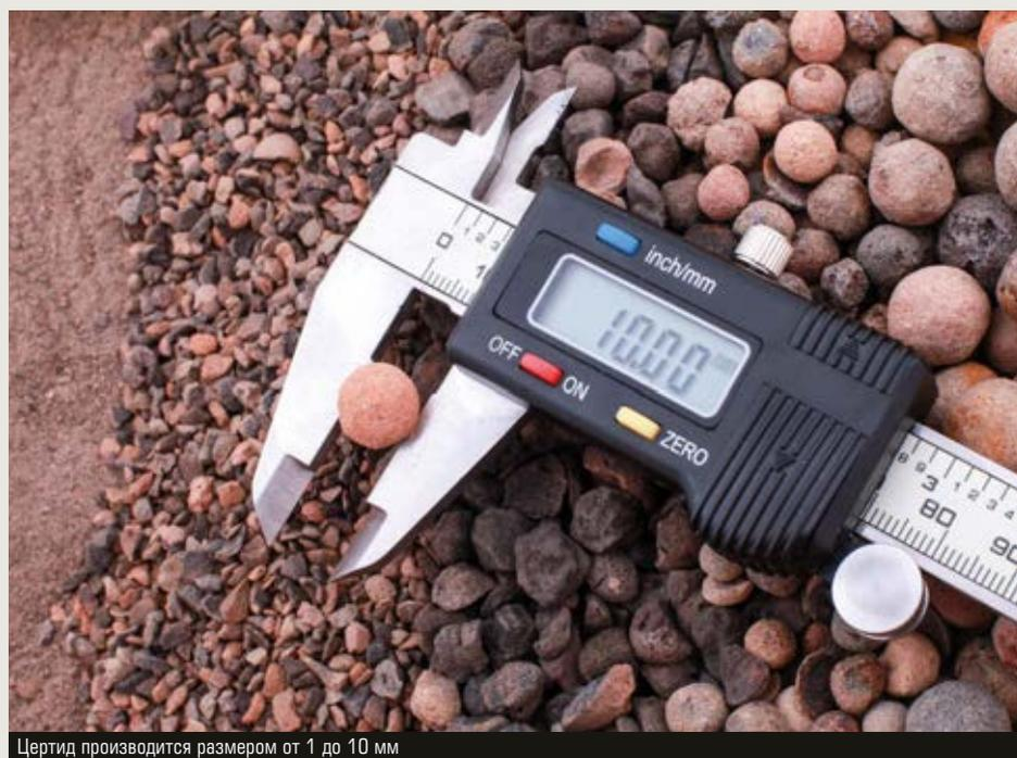
Цертид производится размером от 1 до 10 мм
