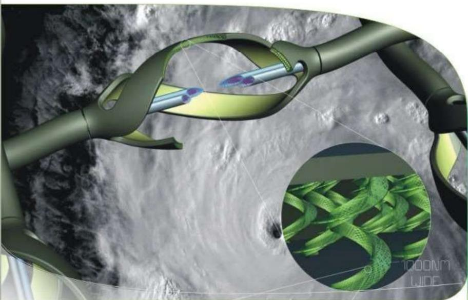
Внешняя часть "живой оболочки" - нано-структура поглощает солнечный свет с помощью органических фотоэлектрических элементов и передает их по нано-волокам внутри нано-проводов, который затем направляется в накопитель, расположенный наконце каждой панели.
