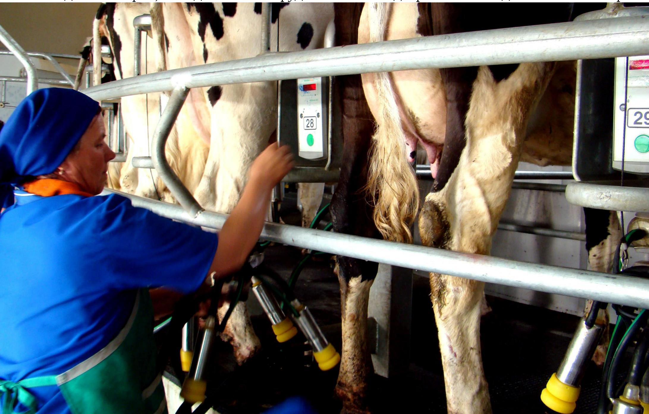
Вымя коровы состоит из 4-х долей. Автоматизированная система определяет сколько в каждой доли содержится молока и доение останавливается поэтапно, по мере того, как молоко в какой-то из долей заканчивается. Оборудование старого поколения не могло останавливать доение поэтапно, что приводило к травмированию животных и снижению их продуктивности.
