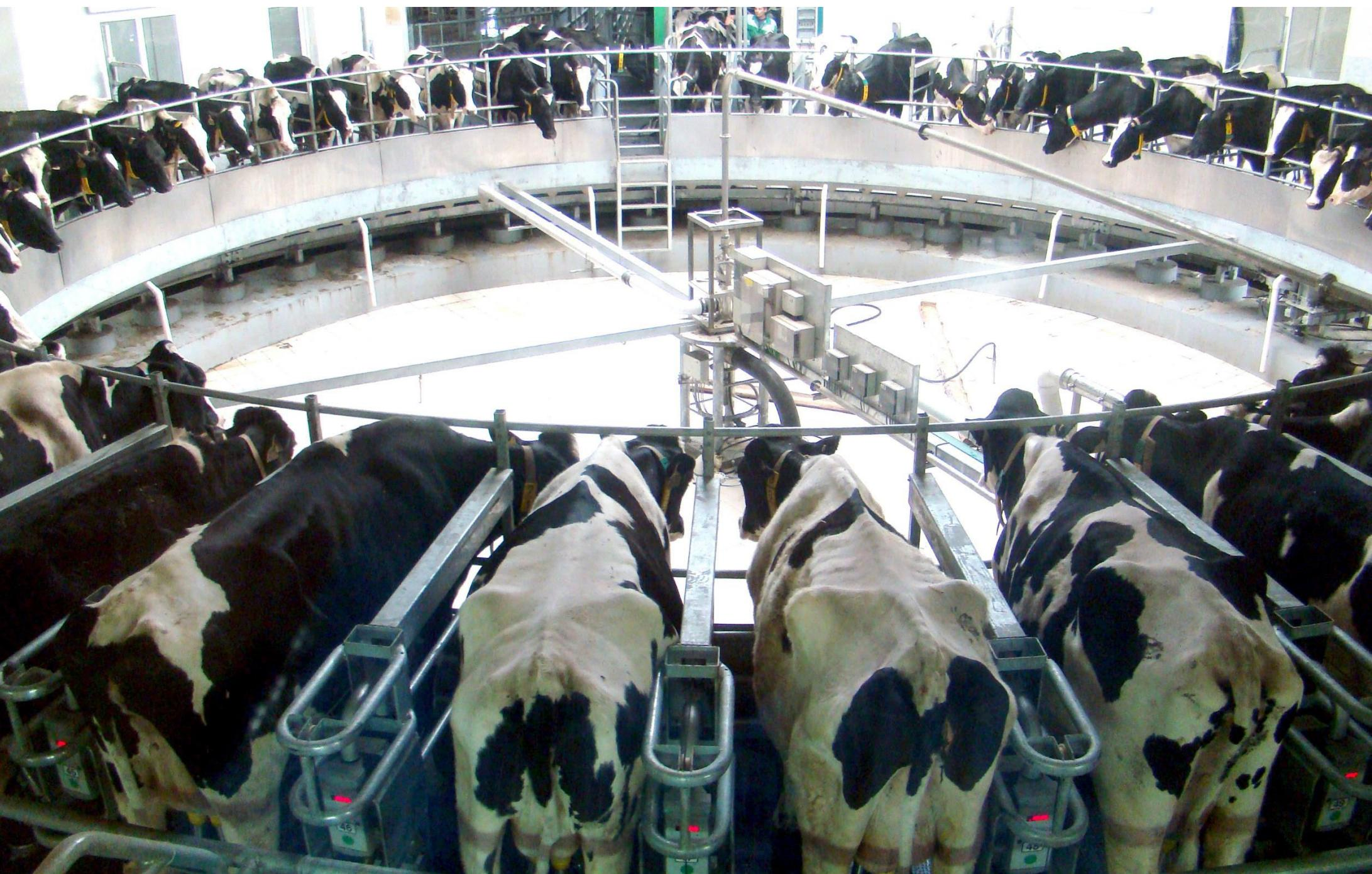
В доильных залах используются современные автоматизированные системы, которые ежедневно проверяют физиологическое состояние коров, определяют режим кормления каждой коровы в зависимости от надоя и облегчают человеческий труд. К примеру, одна доярка за 1 час в ручную может надоить 6 коров, а на доильном оборудовании та же доярка за час надоит более 200 коров.
